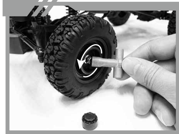
Remove wheel lock nut using the Xwrench and detach wheels. 使用內附之六角螺帽套筒扳手將輪軸上六角固定螺帽取下。
