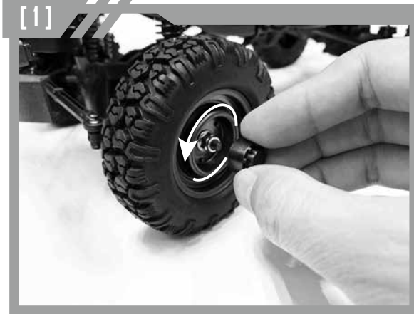
[1] Remove the wheel cap anticlockwise. 以逆時針旋扭將輪框蓋取下。
